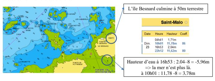
Les zones toujours émergées sont en jaune. Attention, les hauteurs indiquées le sont par rapport au zéro terrestre ou géographique des altitudes. Il diffère du zéro hydrographique. Ce repère a été obtenu par la moyenne des observations des hauteurs d'eau réalisée à Marseille entre 1885 et 1897.
